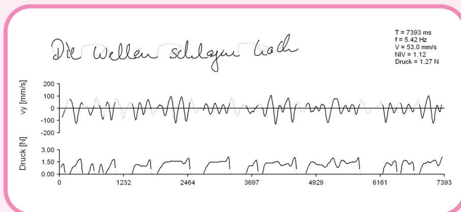
Flüssige Schreibbewegungen bei routiniertem Schreiben. Für den Testsatz werden nur 7,3 Sekunden benötigt. Der Geschwindigkeitsverlauf  $v_y$  (Mitte) zeigt die Regelmäßigkeit der Bewegungsausführung, auch bei Bewegungen in der Luft (gepunktet). Der Schreibdruck (unten) bewegt sich auf konstantem mittleren Niveau
